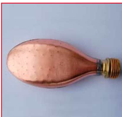
Pebblekopf True Dome Kupfer mit Messinggewinde 3/4", Gravität, 52 Loch, extra fein Ø 0,45, fein Ø 0,50, mittel Ø 0,55, grob Ø 0,60 mm Pomme de pebble True Dome cuivre avec laiton fileté 3/4", force de gravitation, 52 trous, extrafin Ø 0,45, fin Ø 0,50, moyen Ø 0,55, gros Ø 0,60 mm. Pebbler head True Dome copper with brass screw thread 3/4", gravity, 52 holes, extra fine Ø 0,45, fine Ø 0,50, medium Ø 0,55, coarse Ø 0,60 mm
