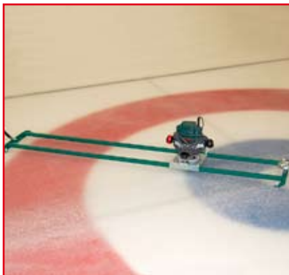
Hauskreisschneidegerät Eisrillen fräsbar mit Elektro-Oberfräser (ohne Oberfräser) Appareil pour tailler les cercles de la maison rainures pouvant être taillées avec la fraiseuse électrique posée sur l'appareil (sans la fraiseuse) Circle cutter cancurl ice grooves millable with electric router (without the router)
