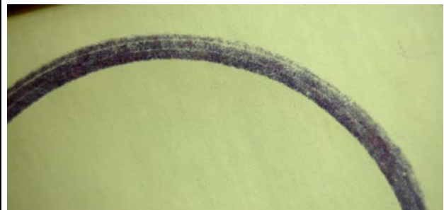
Schleiffrillen in der Lauffläche
